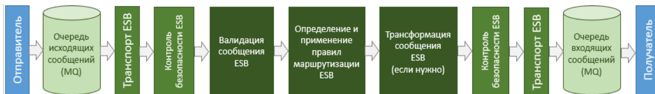
Рис. 2. Последовательность обработки сообщения программными компонентами при передаче между очередями
