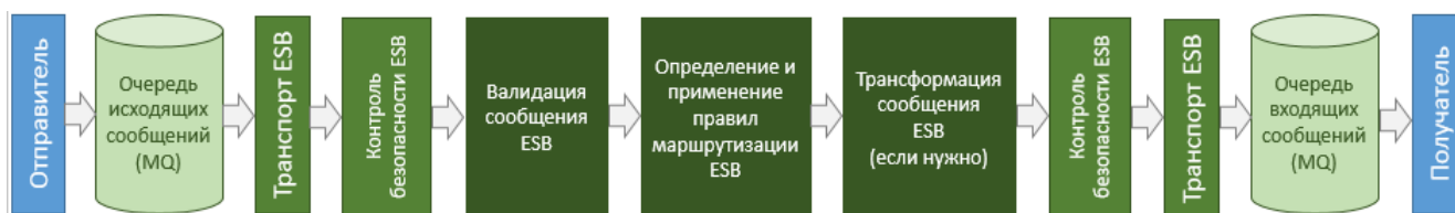
Рис. 11. Последовательность обработки сообщения программными компонентами при передаче между очередями
