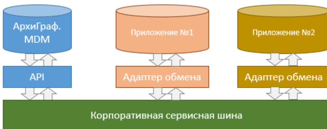
Рис. 10. Архитектура обмена с АрхиГраф.MDM
